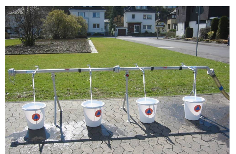
Wasserzapfstelle zur Trinkwasserversorgung (Foto: BBK)
